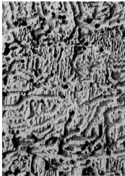
Afbeelding: inwendige aantasting door de gewone houtwormkever.
