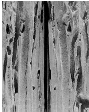
Afbeelding: inwendige aantasting door de huisboktor
