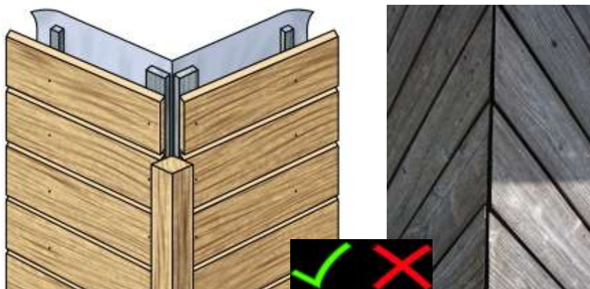
Tekening 3. Voorbeeld open gevelbekleding met afgeschuinde delen met goed voorbeeld hoekoplossing.
