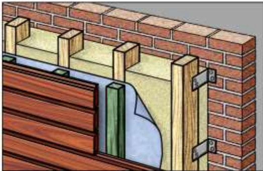
Tekening 4. Opbouw gevelbekledingsconstructie bij een steenachtig binnenspouwblad, regelwerk verduurzaamd.
