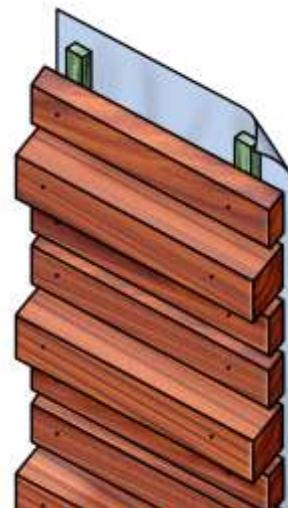
Tekening 1b.: Horizontale open gevelbekleding met variabele afmetingen, trapeziumvormig voor goede afwatering
