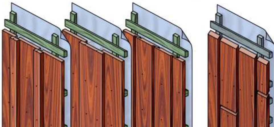
Tekening 2a. Verticale gevelbekleding. V.l.n.r. opdekwerk, opdekwerk en rabat met halfhoutse overlap (Channel siding).
