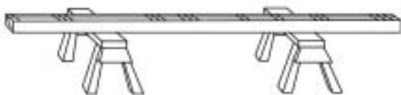
STAP 1 Markeren van de plaatsen van de stijlen op onder- en bovenregel.
